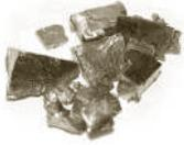
**COLUMBITA-TANTALITA**, de la columbita se obtiene el niobio y de la tantalita el tántalo, que es un metal muy maleable que conduce bien la electricidad y el calor, con una alta resistencia a la corrosión. Por esta razón es un componente clave en multitud de componentes, incluyendo circuitos, condensadores, lentes y discos duros.
